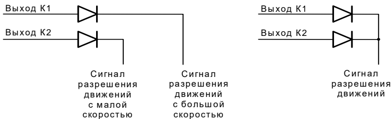
Рисунок 10 – Варианты подключения выходных реле (электронных ключей)
